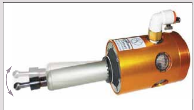
徑向標準去毛刺工具擁有專利設計而在整個360度提供徑向柔通過該中心的內部氣動活塞運動在使用過程中主軸。
